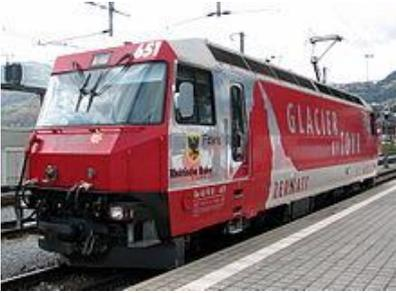
Neue Loks GE 4/4 III für den Sandwich-Betrieb (Push-Pull).
