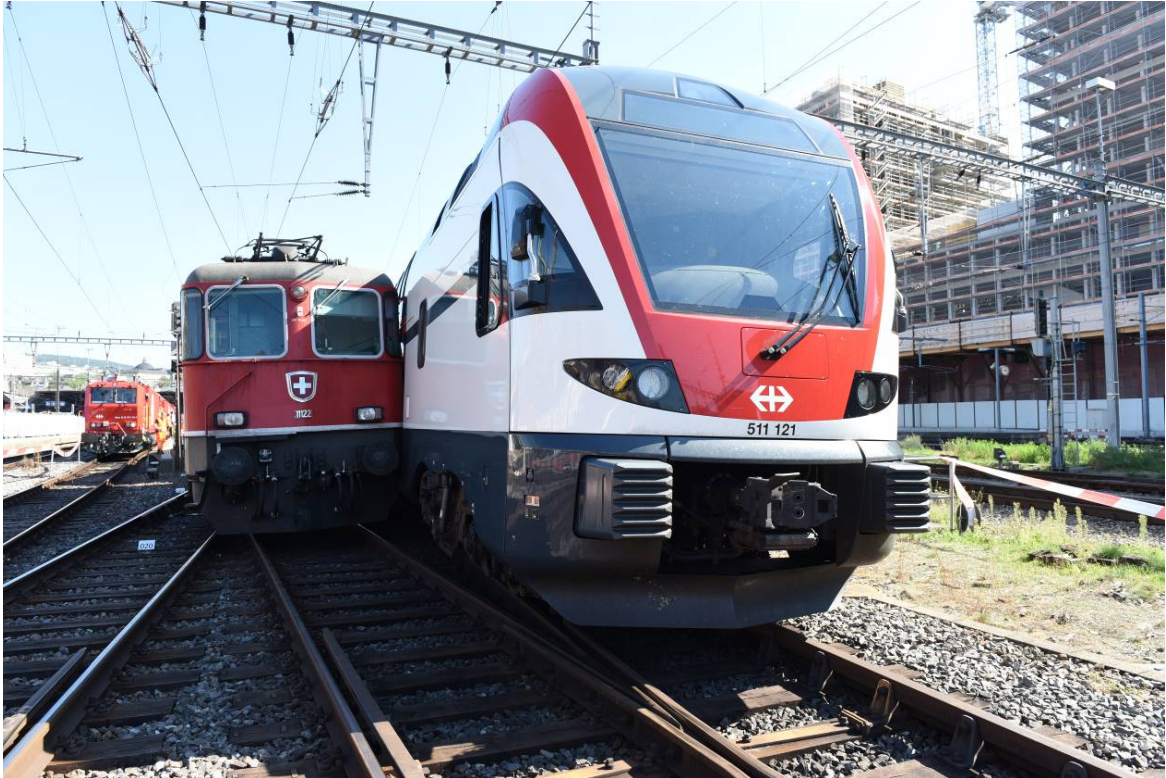
Abbildung 2: Kollision zwischen dem IC 3 (links) und dem Doppelstocktriebzug (Rangierbewegung) (rechts). (Bildquelle: Kapo Zürich)
